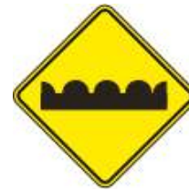
P.11.(a) PERFIL IRREGULAR (calzada irregular)
