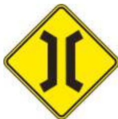
P.16 PUENTE ANGOSTO
